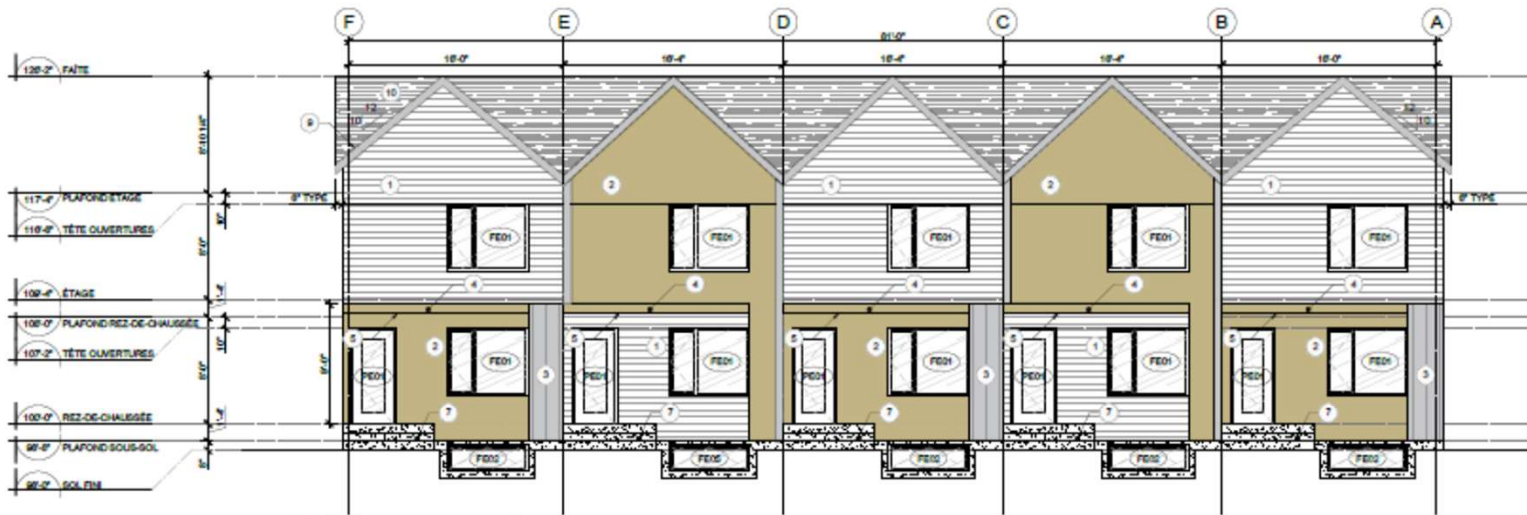
01 ÉLÉVATION AVANT BÂTIMENT 1 A100 ÉCHELLE : 3/16"=1'-0"
